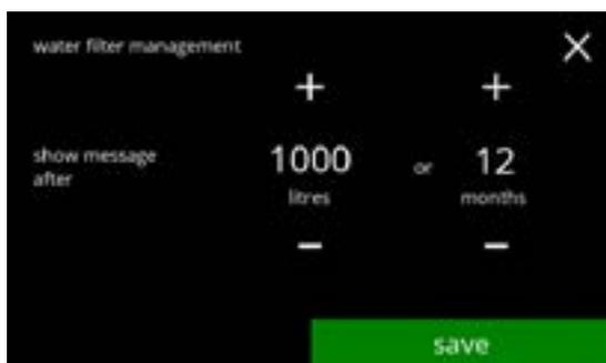
Die Meldung „Wasserfilter ersetzen“ einstellen:
